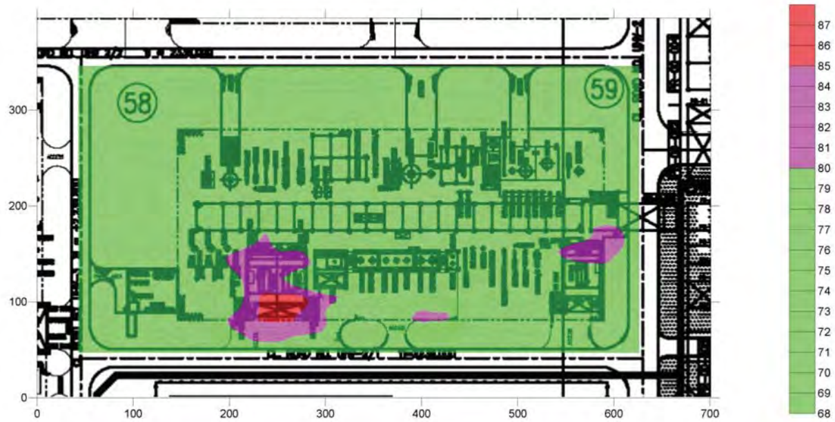
รูปที่ 24 ผังแสดงระดับเสียงบริเวณพื้นที่กระบวนการผลิต แบบแถบสี บริเวณพื้นที่ RCPR 58-59
