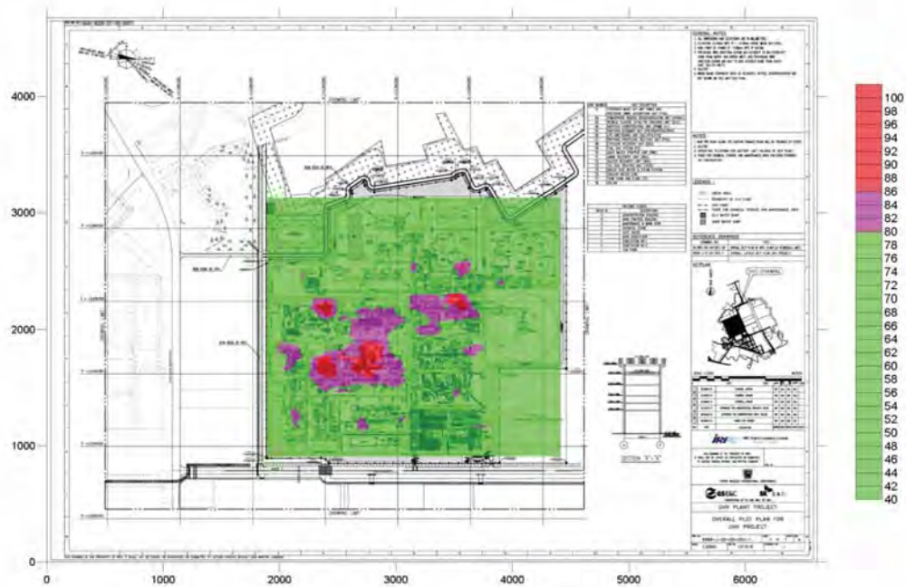
รูปที่ 54 ผังแสดงระดับเสียงบริเวณพื้นที่กระบวนการผลิต แบบแถบสี บริเวณพื้นที่ UHV
