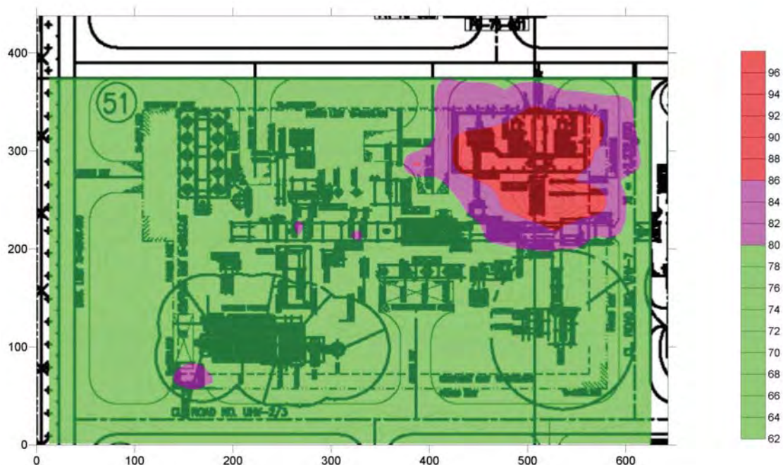
รูปที่ 3 ผังแสดงระดับเสียงบริเวณพื้นที่กระบวนการผลิต แบบแถบสี บริเวณพื้นที่ RCHS 51
